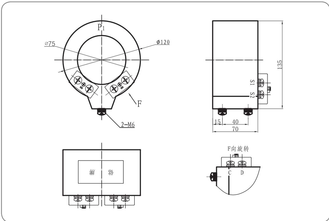
套管式W型电流互感器
